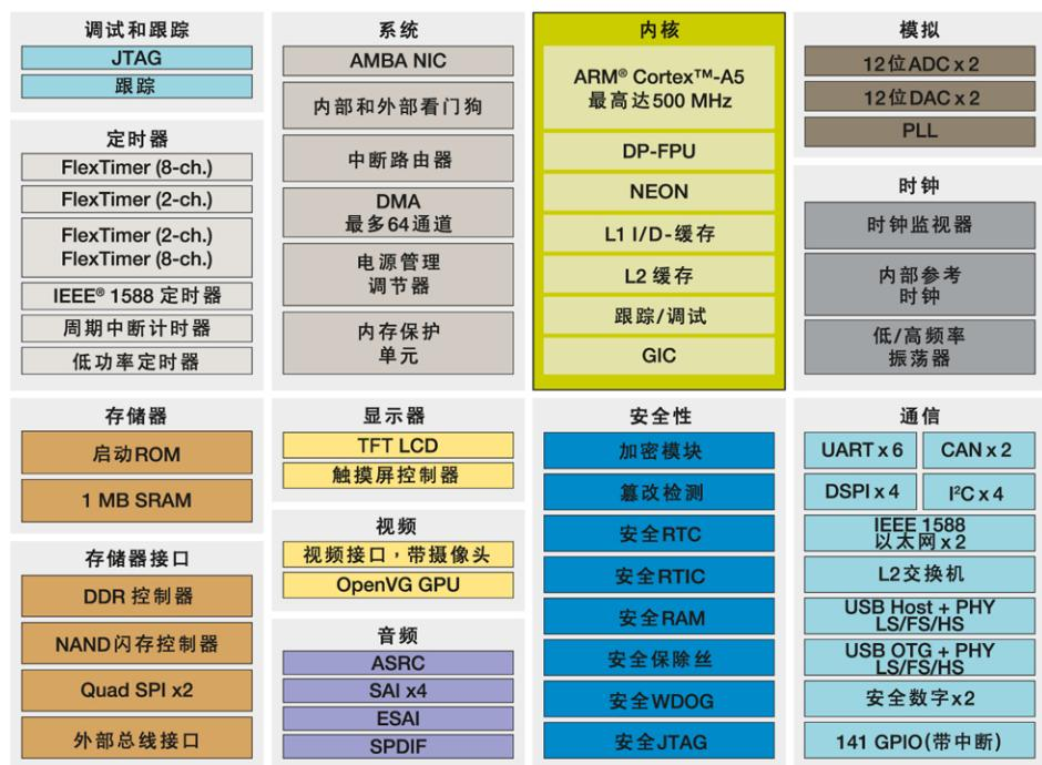
Vybrid VF5xx可以与各种外设和存储器接口，实现系统扩展和数据存储。双Quad SPI支持芯片内执行(Execute-in-Place，XiP)，安全的双数字主机控制器，NAND闪存及DRAM控制器(支持ECC)等接口，使关键应用能够连接到各种不同的存储器。
