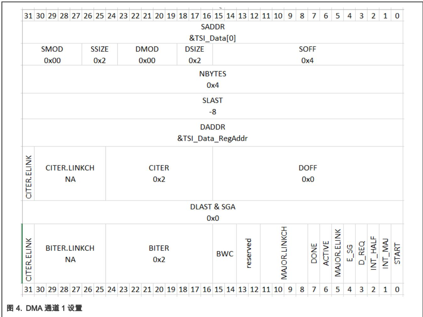
图 4. DMA 通道 1 设置
