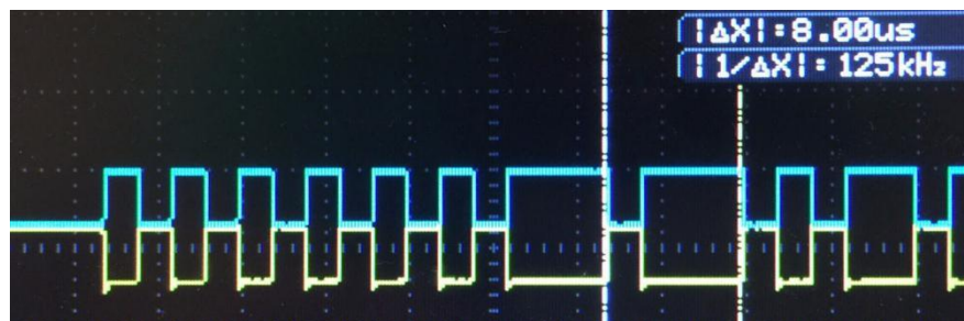
图14.标准ID为0x555的CAN 2.0传输帧开始时的CANH、CANL
