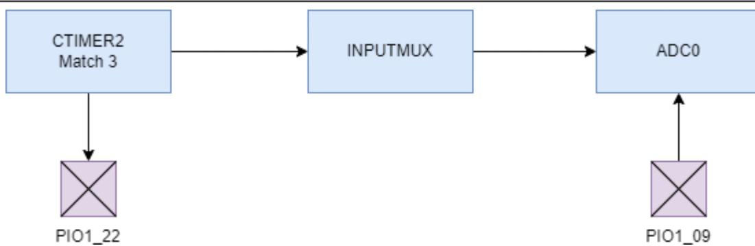
图3. ADC CTimer互连的示例
