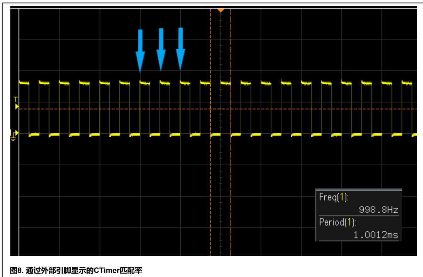
图8. 通过外部引脚显示的CTimer匹配率
