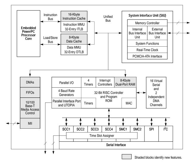
Figure 1-1. MPC860P Block Diagram
