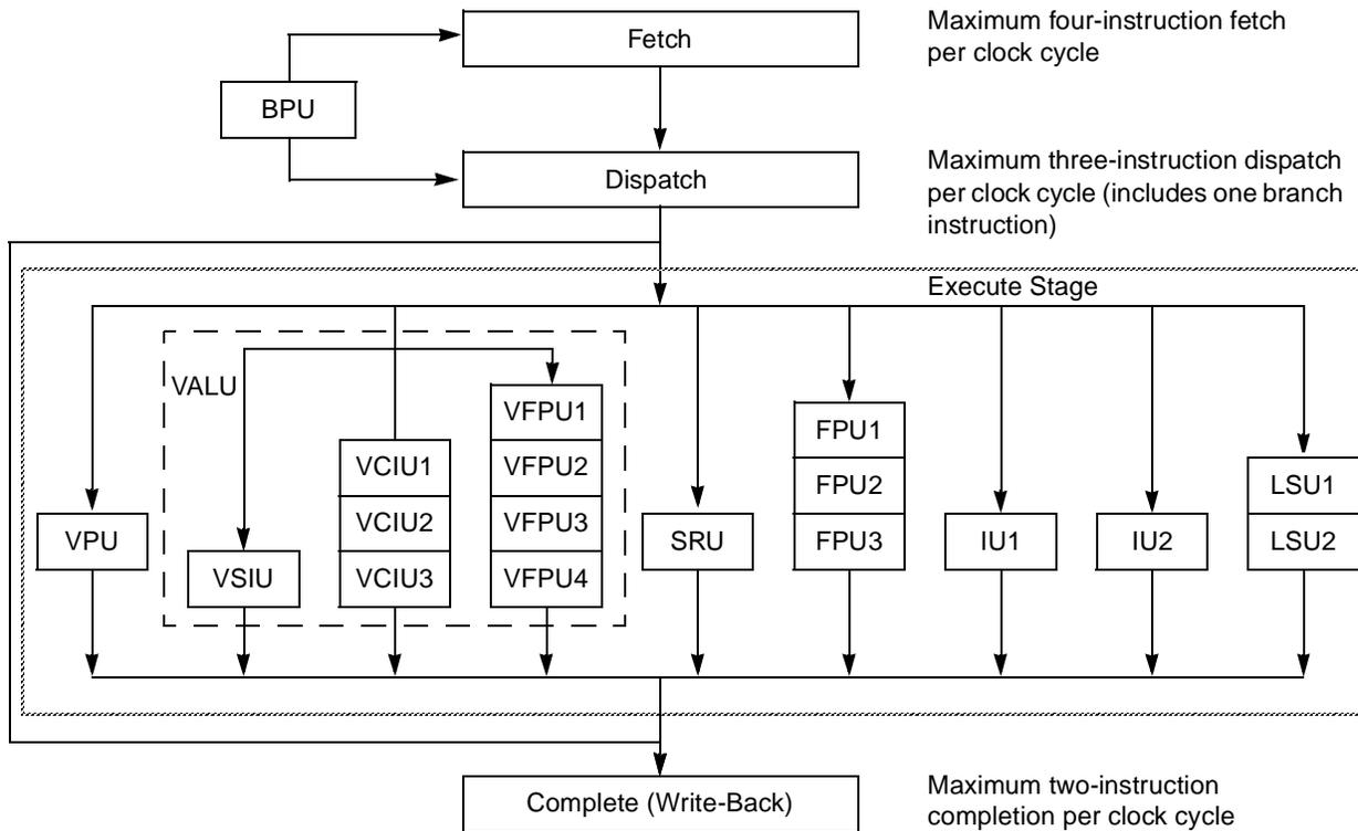
**Figure 1-6. Pipeline Diagram**
