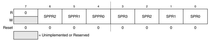
Figure 15-7. SPI Baud Rate Register (SPIBR)
