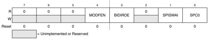
Figure 15-6. SPI Control Register 2 (SPIC2)
