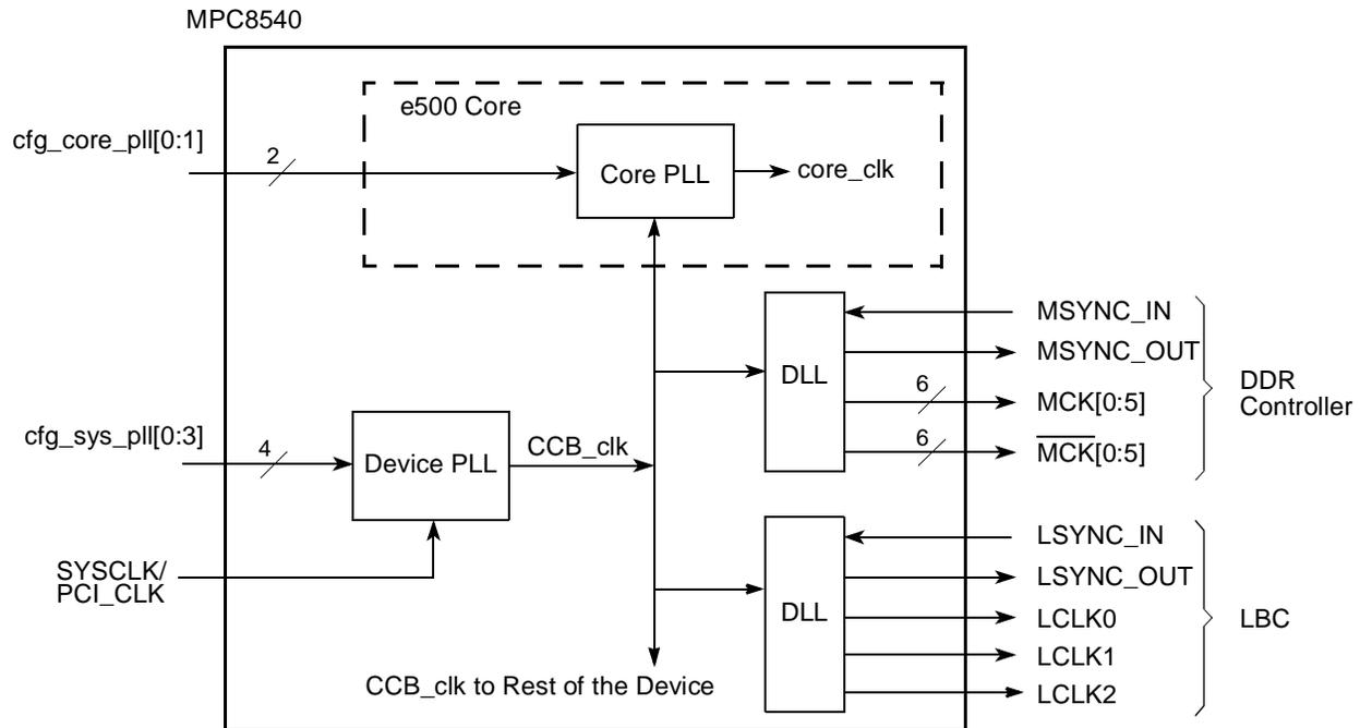
**Figure 2. Clock Subsystem Block Diagram**
