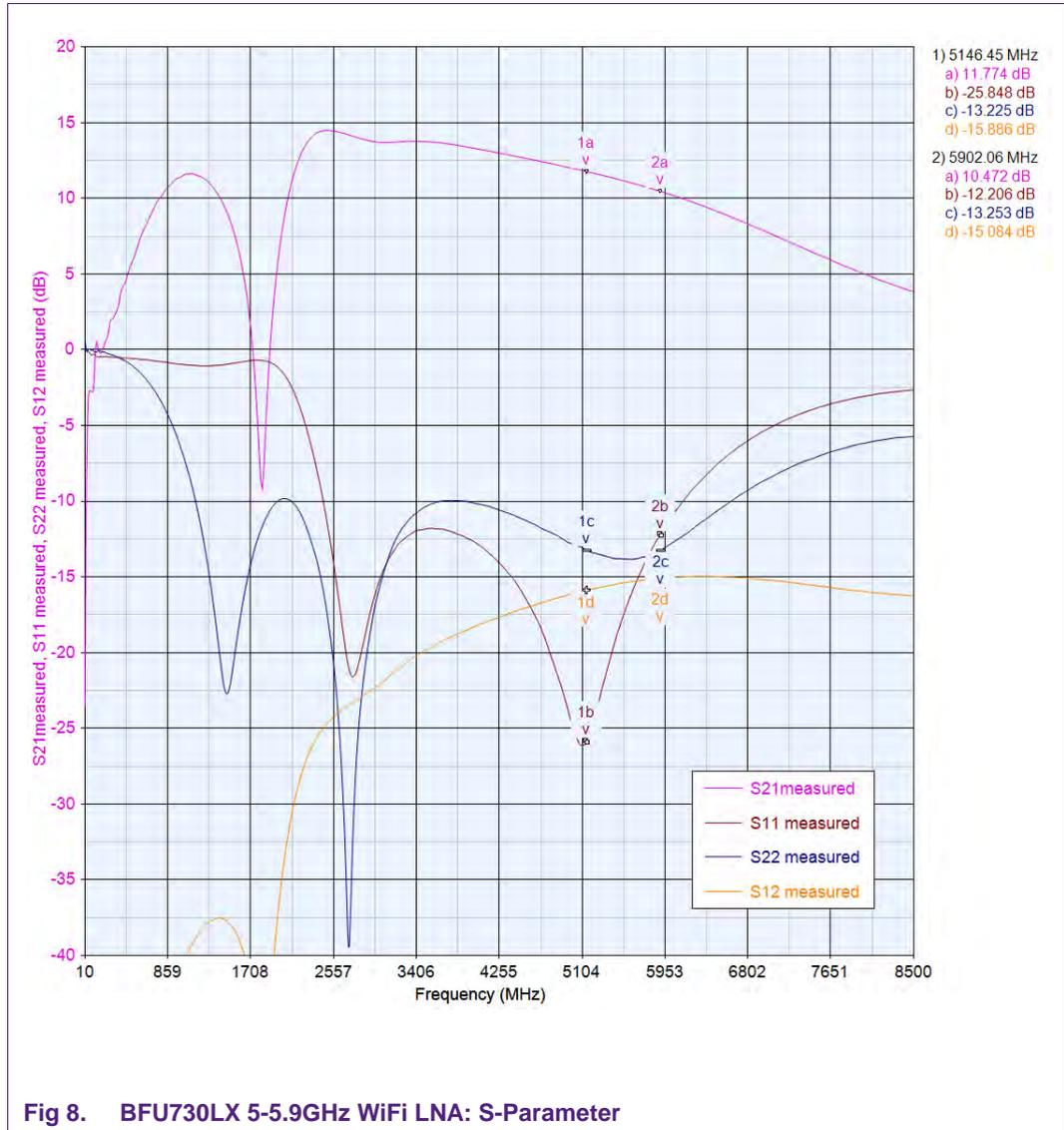
Fig 8. BFU730LX 5-5.9GHz WiFi LNA: S-Parameter
