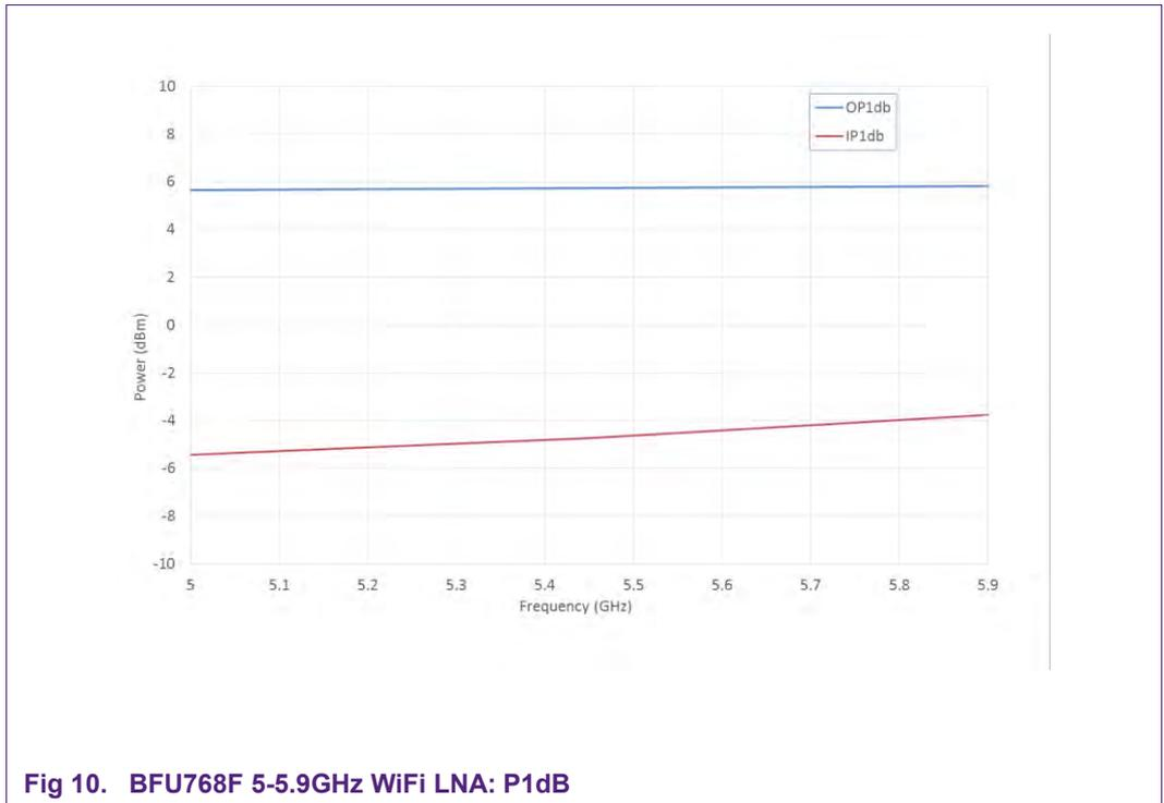
Fig 10. BFU768F 5-5.9GHz WiFi LNA: P1dB
