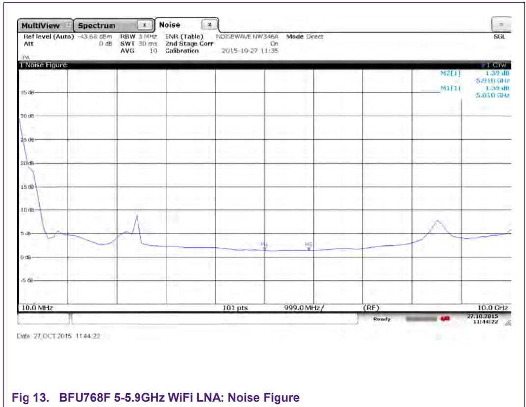
Fig 13. BFU768F 5-5.9GHz WiFi LNA: Noise Figure
