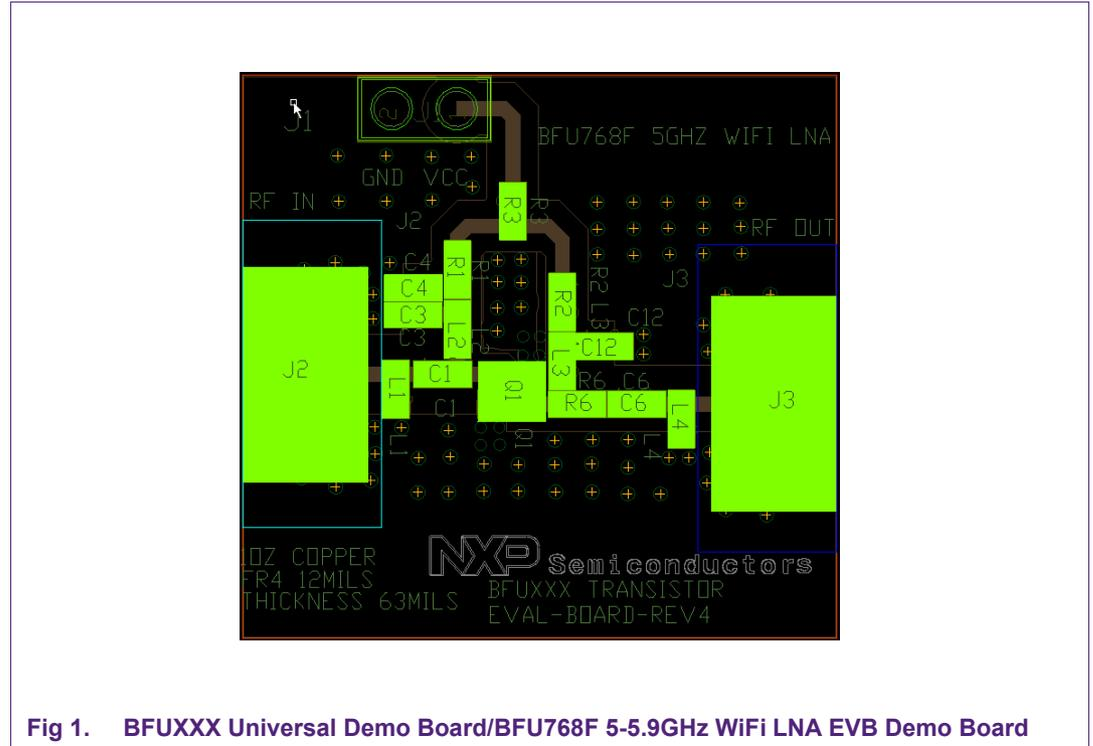
Fig 1. BFUXXX Universal Demo Board/BFU768F 5-5.9GHz WiFi LNA EVB Demo Board
