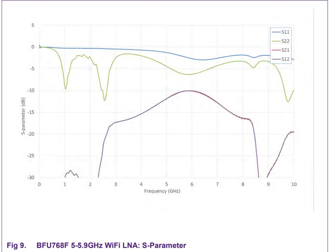
Fig 9. BFU768F 5-5.9GHz WiFi LNA: S-Parameter
